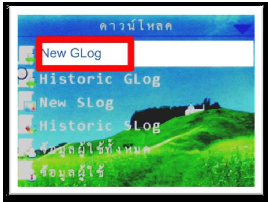
เลือกเมนู “New GLog” สำหรับส่งออกข้อมูลบันทึกเวลาไปที่ Flash Drive
